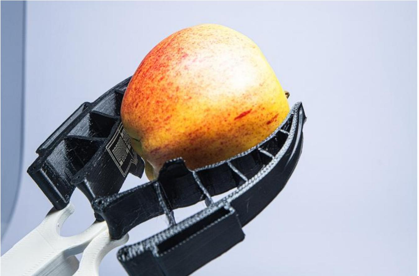
Robotergreifer mit haptischen Fähigkeiten können Äpfel und anderes Obst künftig schonender fassen und sortieren. Dabei passt sich der im Projekt BioGrip entwickelte Greifer der Apfelform an.
