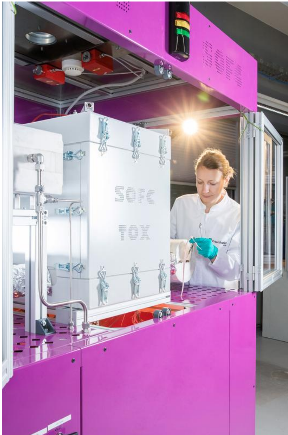
Demonstrationsanlage zur CO 2 -freien Stromerzeugung mit Ammoniak in Hochtemperatur-Brennstoffzellen (SOFC) © Fraunhofer IKTS
