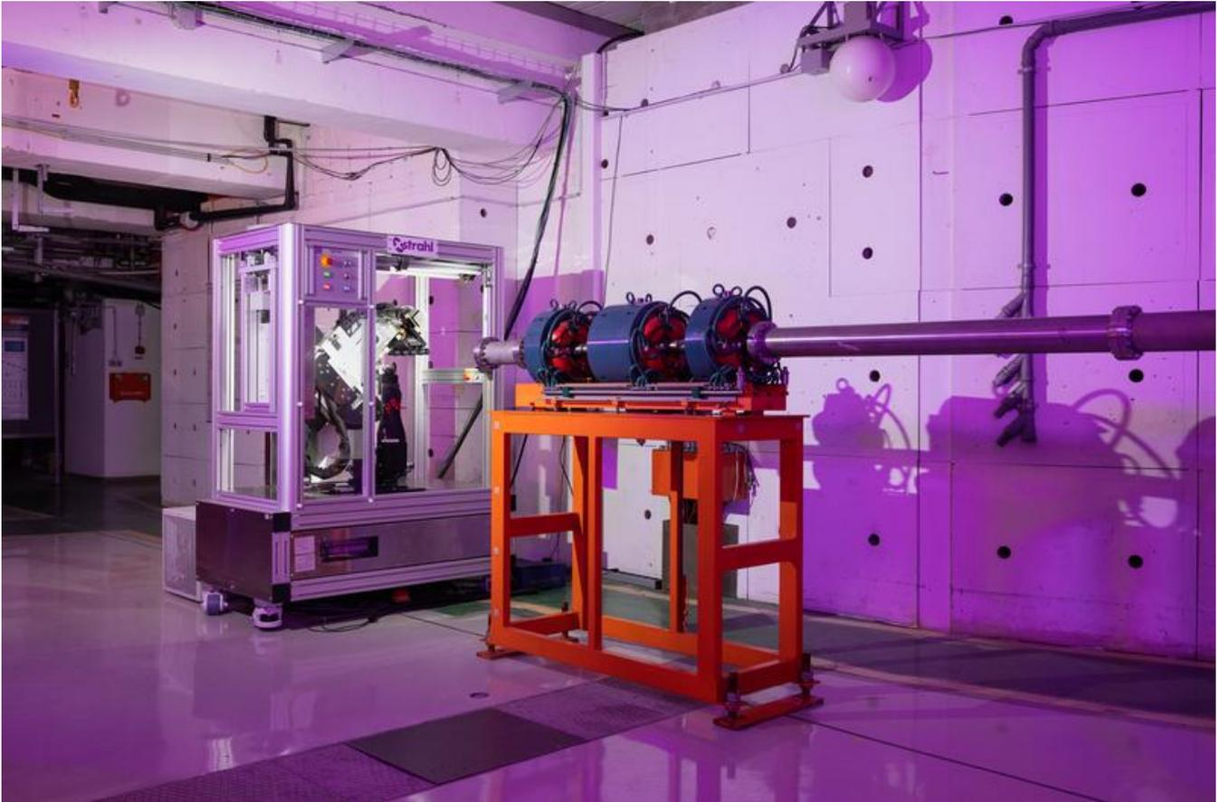
Magnetische Quadrupole fokussieren den Protonenstrahl vor der Experimentplattform.
