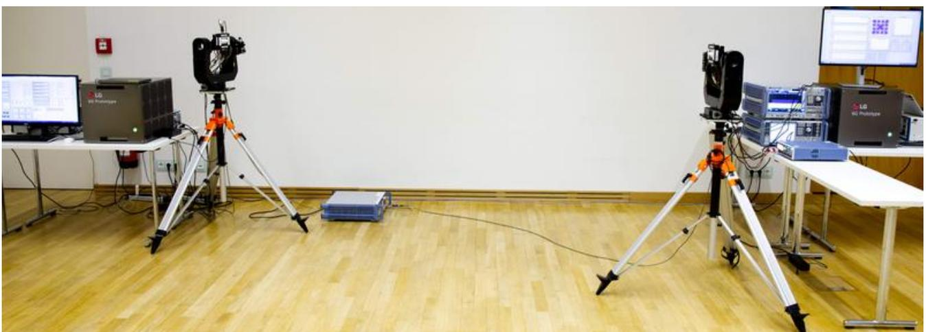
Die Forschenden haben einen hochmodernen Front-End-Prototyp (Radio-Head) entwickelt, der mehr als 50 dBm (100 Watt) EIRP-Ausgangsleistung liefert.
