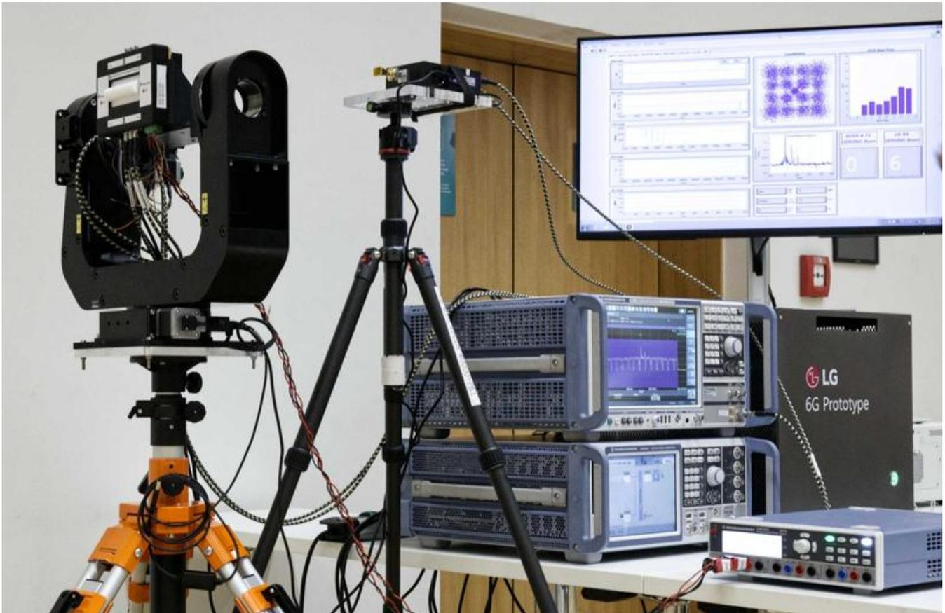
Forschende der Institute Fraunhofer IAF und HHI haben gemeinsam mit LG Electronics den weltweit ersten erfolgreichen Versuch von D-Band-Hybrid-Beamforming mit zweikanaligen analogen Beamforming-Front-Ends durchgeführt.
