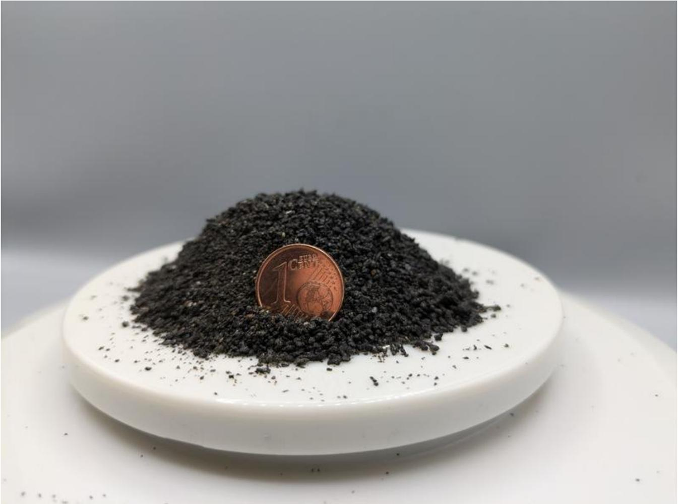
Gummiabrieb bei typischer Reifenverschleißrate (30 g pro 100 km) – im Projekt RAMUS untersuchen Forschende Entstehungsfaktoren und Einflussgrößen.
