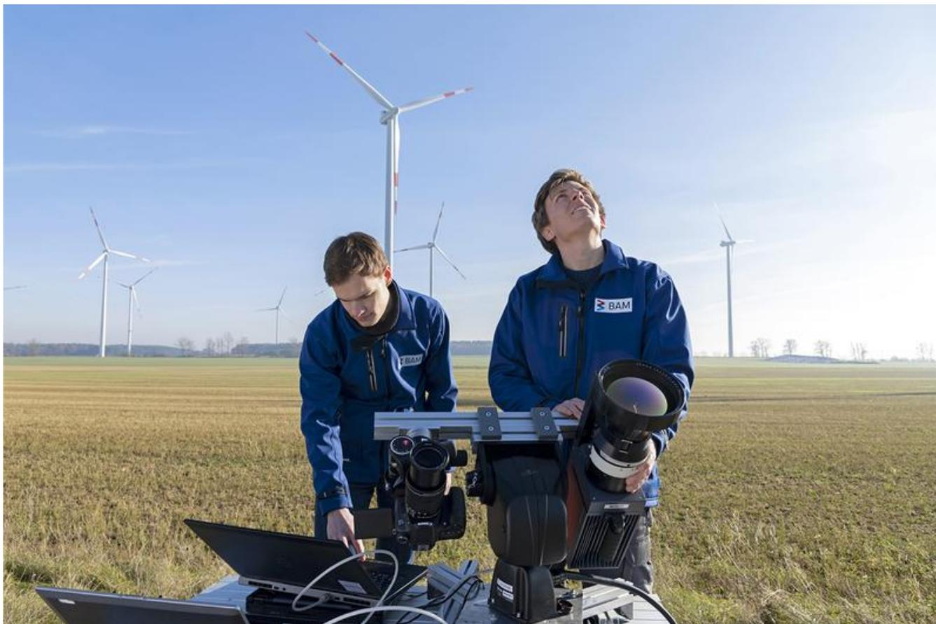
Mit einer Wärmebildkamera lassen sich frühzeitig Materialschwächen an einem Rotorblatt erkennen.
