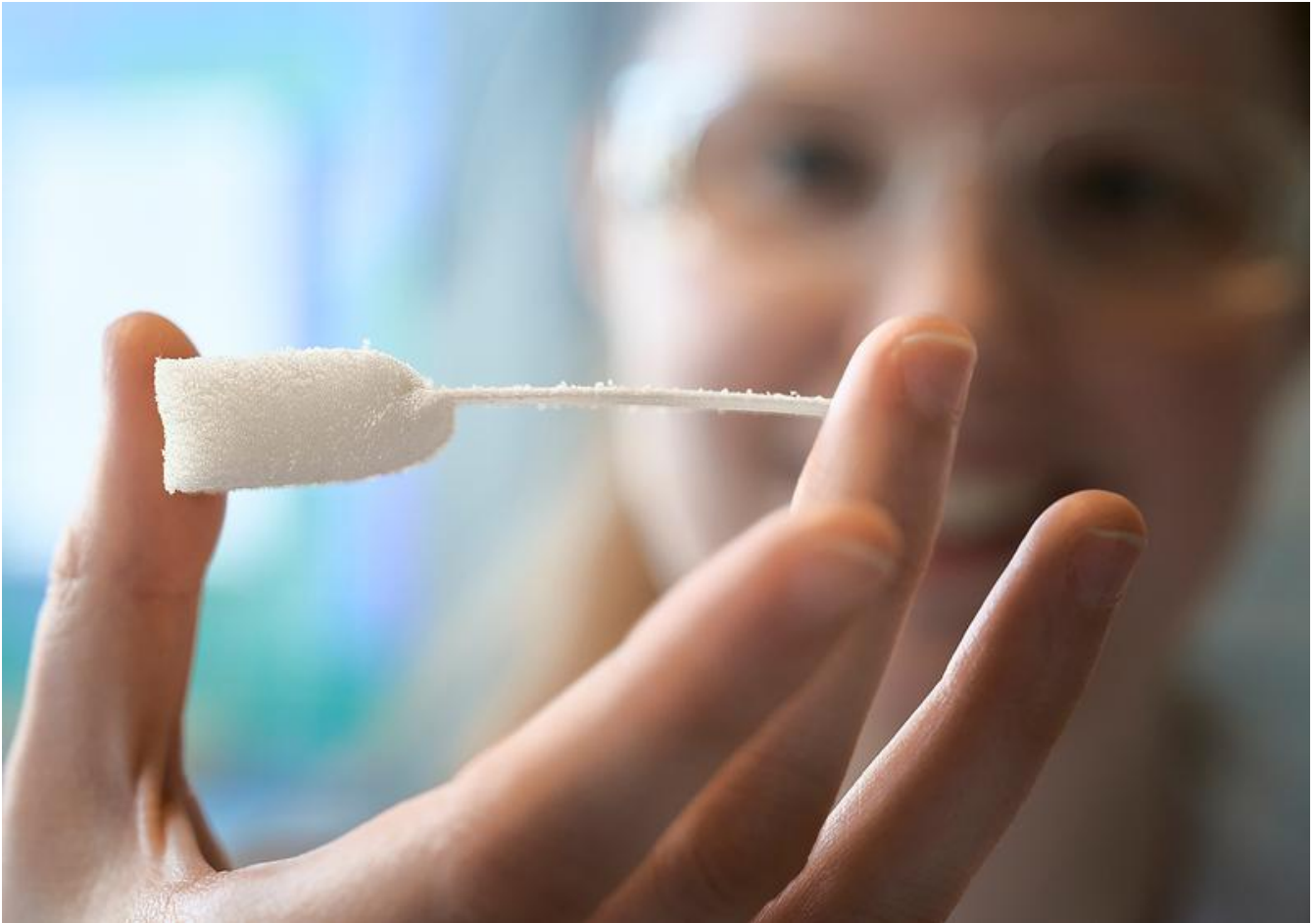
Die neuartige Folie schäumt durch Wärme zu einem Polyurethan-Schaum auf. Dabei werden keine Isocyanate freigesetzt. Fraunhofer IAP, Jadwiga Galties
