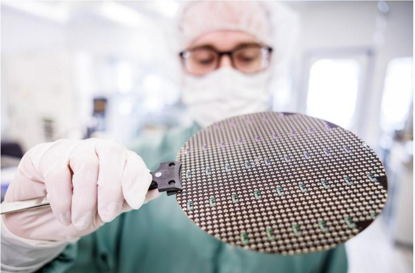
Leistungsbaulemente auf einem Siliziumkarbid-Wafer, hergestellt im institutseigenen Reinraum des Fraunhofer IISB.
