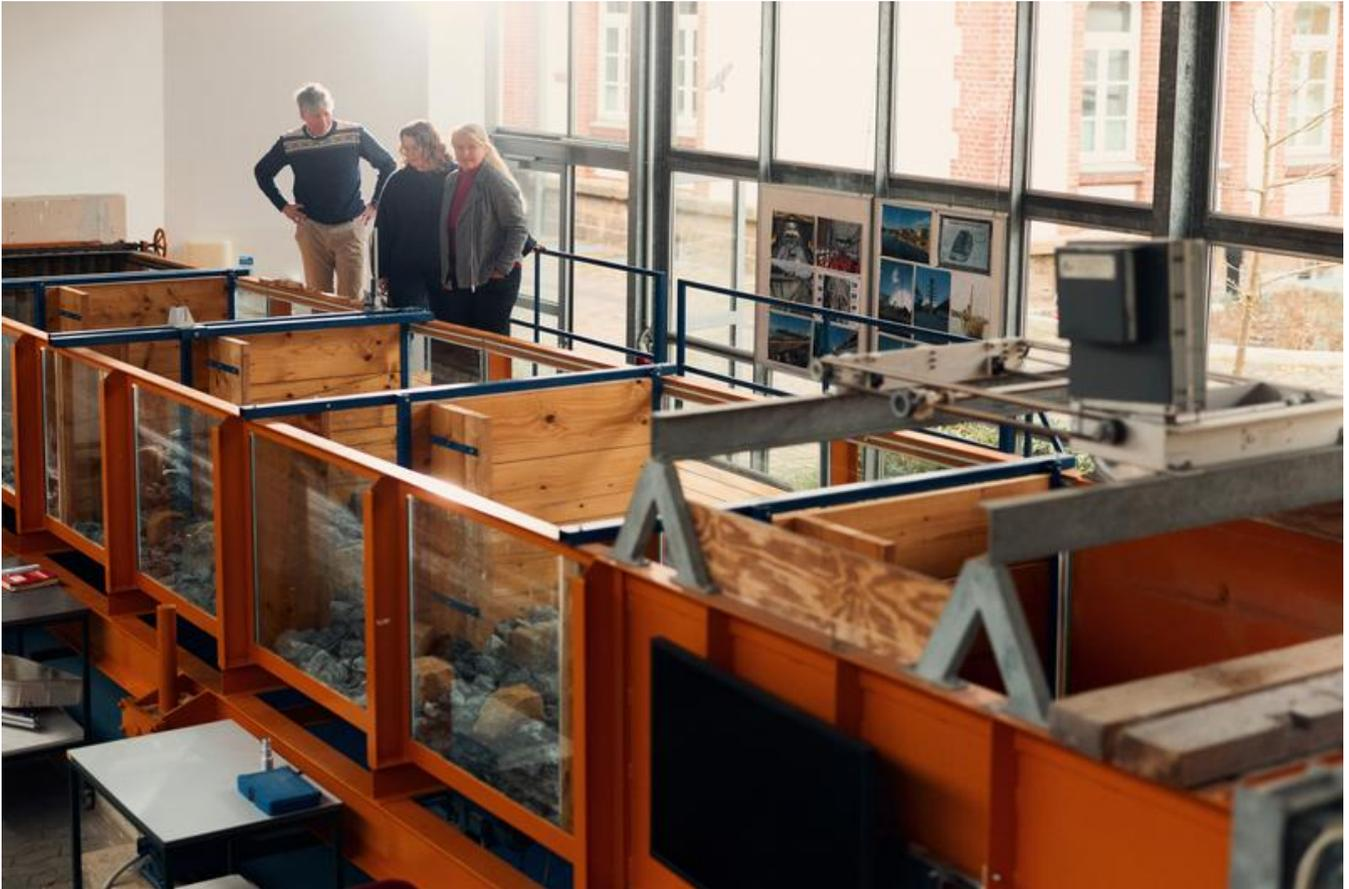
Am Strömungskanal im Wasserbaulabor auf dem Campus Minden lässt sich nachvollziehen, mit welchen Kräften Wasser auch auf Spundwände wirkt.
