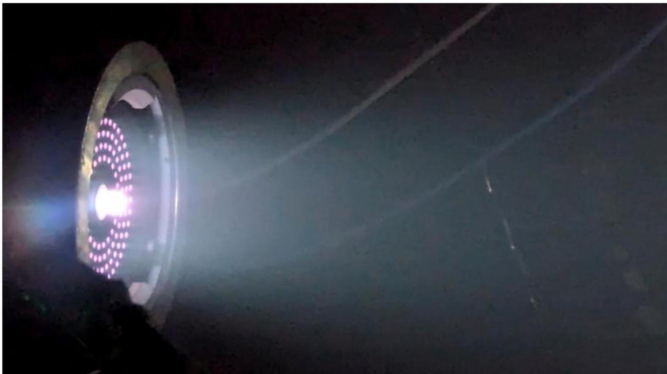
IOM-Ionentriebwerk in Betrieb.
