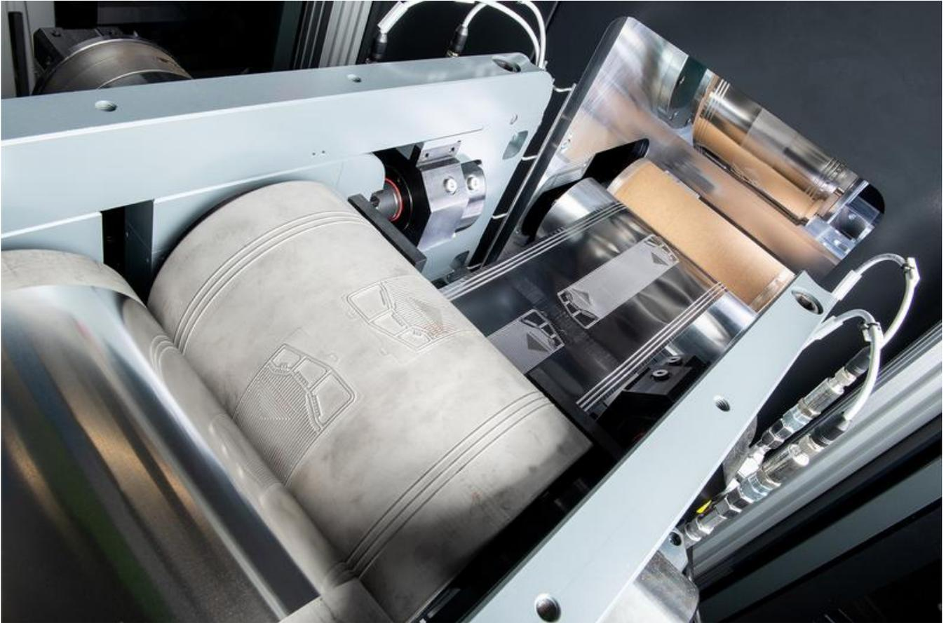
Kontinuierliches Walzprägen zur Produktion von Bipolarplatten
