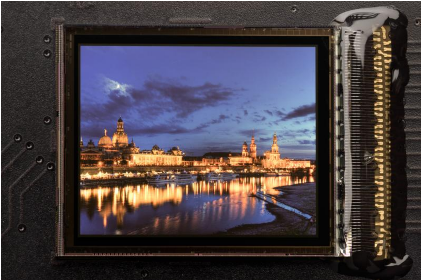
6,2-Zoll-SXGA-Hochvolt-CMOS-Backplane mit OLED © Fraunhofer IPMS
