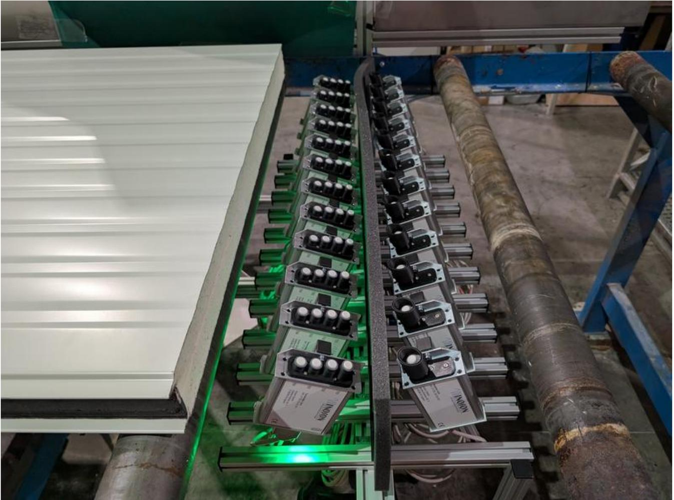
Die neue zerstörungsfreie und berührungslose Messtechnik identifiziert mögliche Schwachstellen von Sandwichelementen bereits während der Produktion, direkt danach sowie im verbauten Zustand
