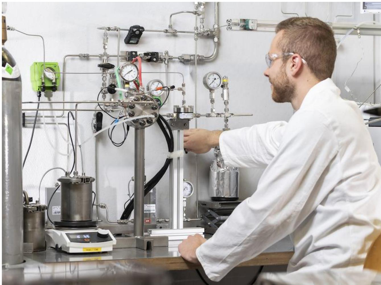
Die Forschenden stellen einen neuen Reaktor vor, der Kohlendioxid (CO<sub>2</sub>) unter Verwendung von unter Druck stehendem CO<sub>2</sub> und reinem Wasser effizient in wertvolle Chemikalien umwandelt.
