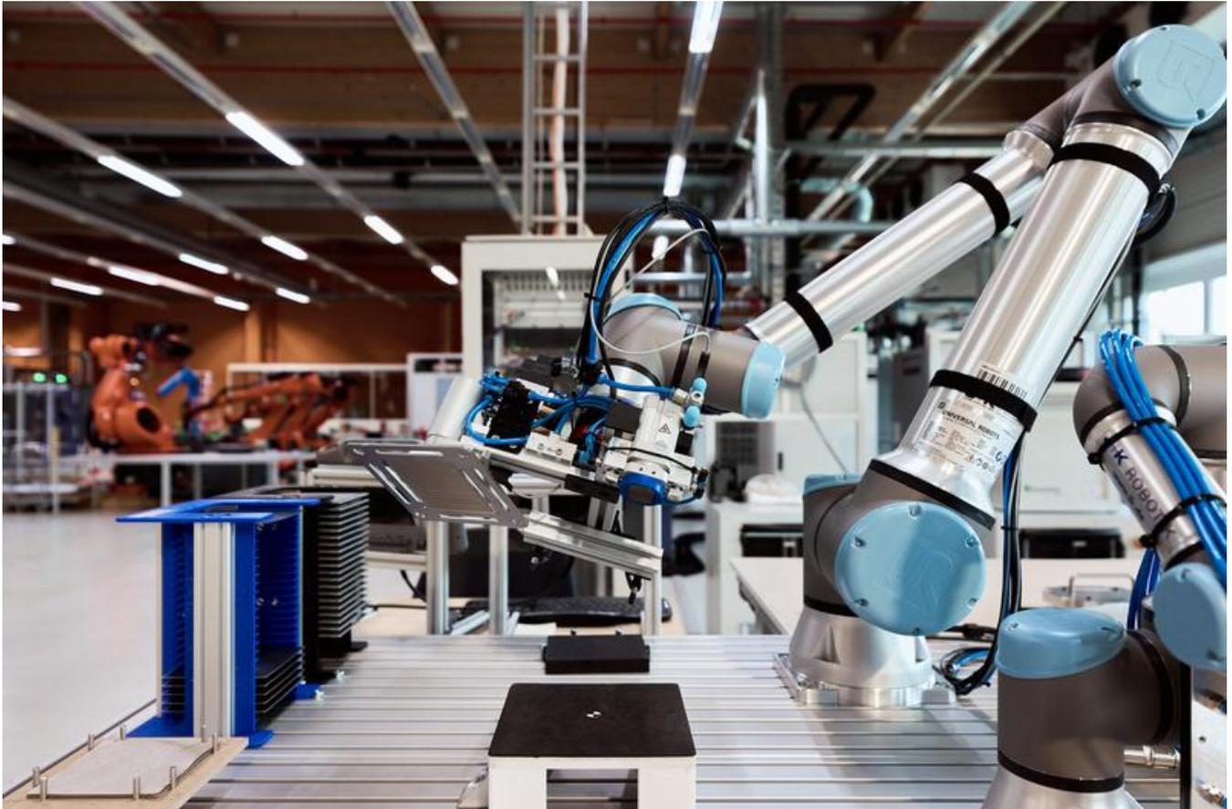
Mithilfe von Cobots können automatisierte Fertigungsprozesse, zum Beispiel bei der Montage von Elektrolyse-Stacks, entwickelt, implementiert und validiert werden.
