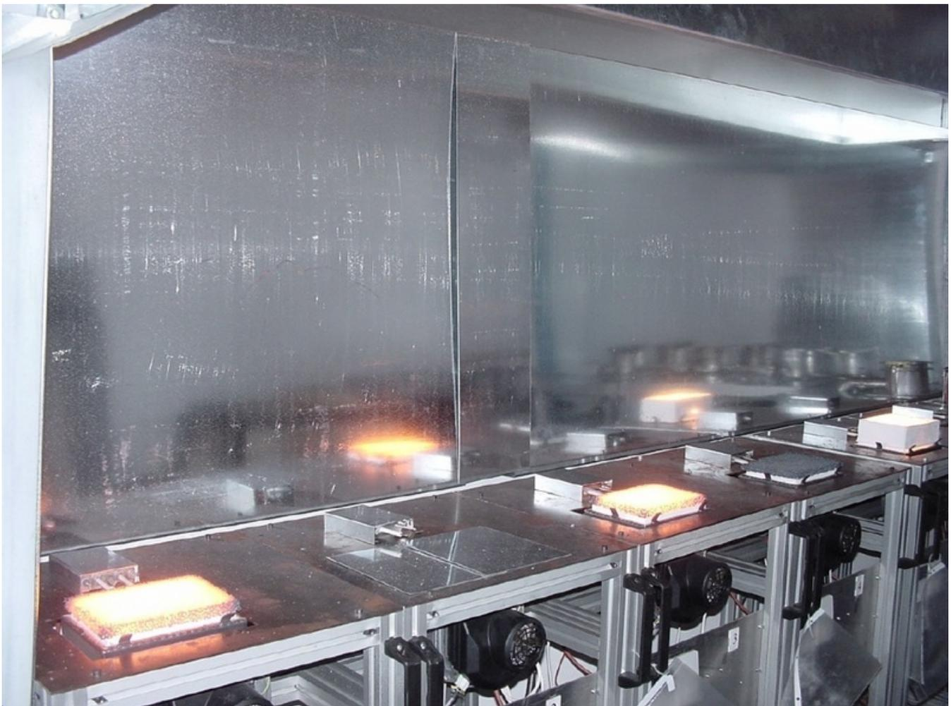
Porenbrennerelemente auf dem Dauerprüfstand. Foto: LSTM
