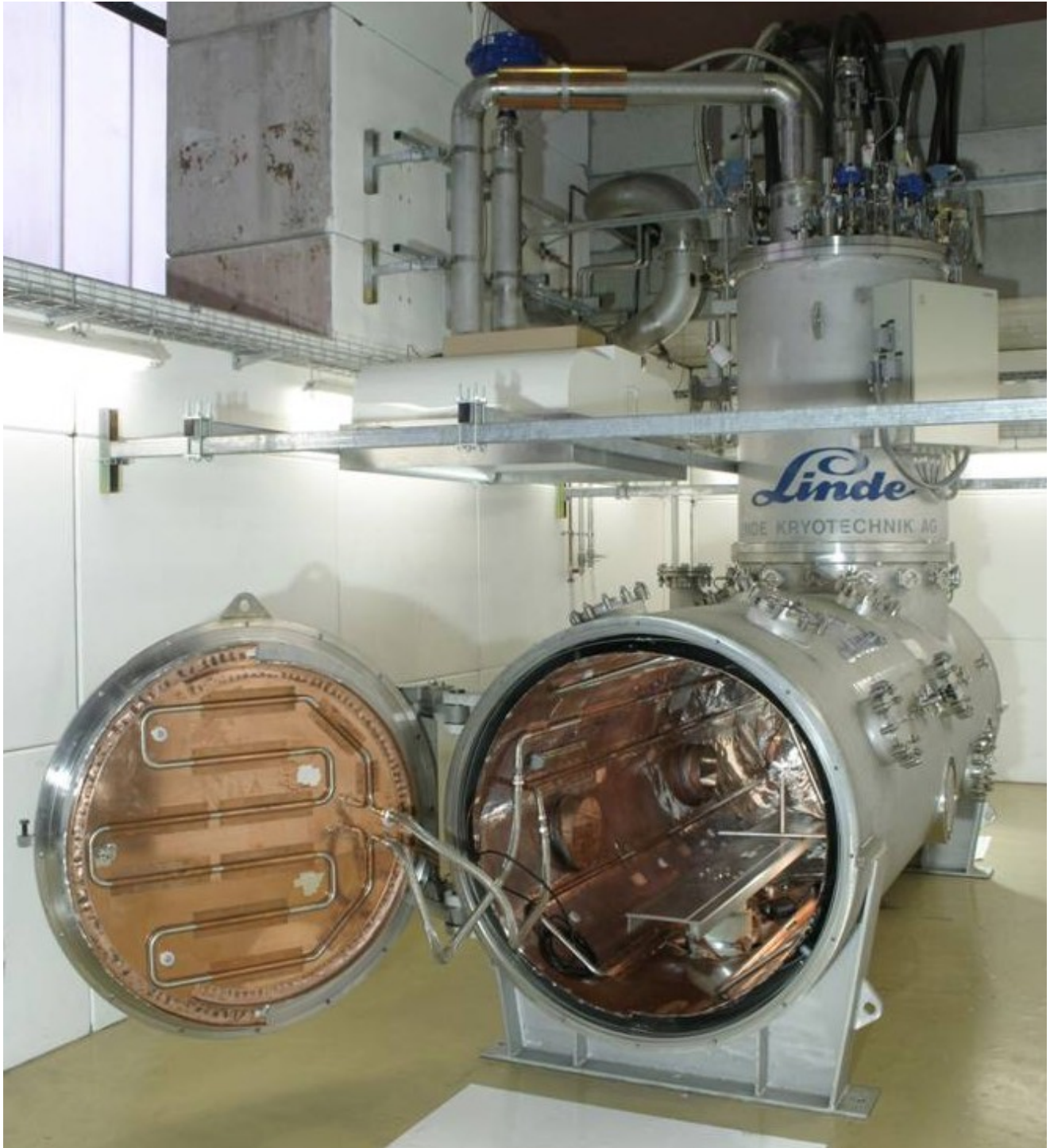
Der bei BESSY aufgebaute Teststand HoBiCaT, in dem u.a. untersucht wird, wie sich die bei DESY entwickelten supraleitenden TESLA-Cavities bei ihrer Betriebstemperatur von -271^{\circ}\text{C} verhalten. Diese Cavities (Hohlraumresonatoren) sind wichtige Elemente moderner FEL. © BESSY / Schurian
