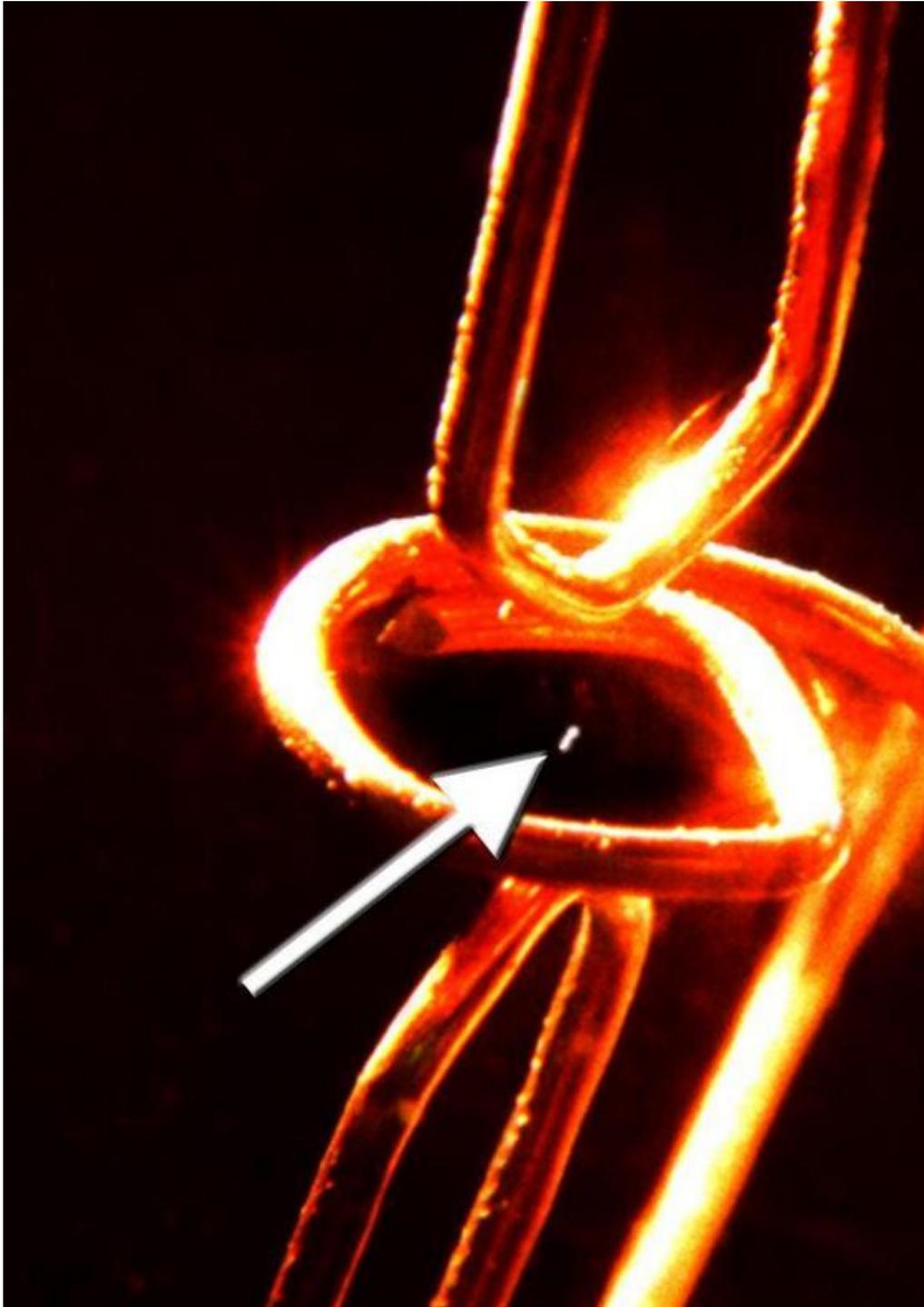
So funktioniert eine Ionenfalle: An der Spitze der beiden gegenüberstehenden und an die zu einem Ring gebogene Büroklammer wird eine Wechselspannung angelegt. Dadurch läßt sich zum Beispiel ein Staubteilchen (siehe Pfeil) in der Schwebe halten.
