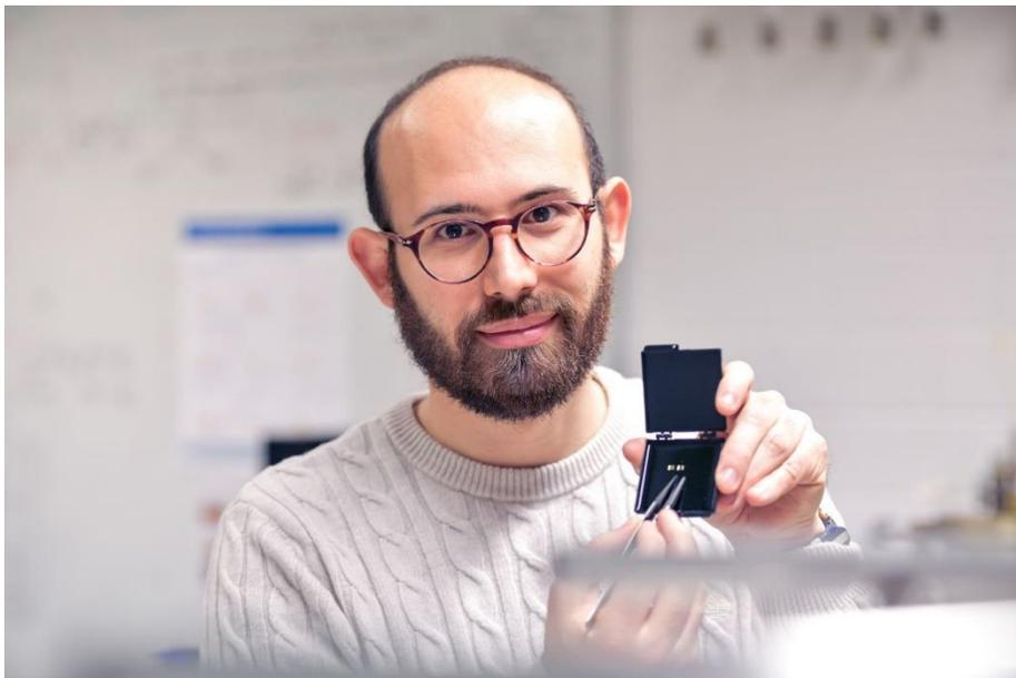
Lorenzo Tesi zeigt zwei Prototypen von künstlichen Oberflächen, die er für die Erforschung von molekularen Spin-Qubits bei Terahertz-Frequenzen entwickelt hat. Foto: Max Kovalenko
