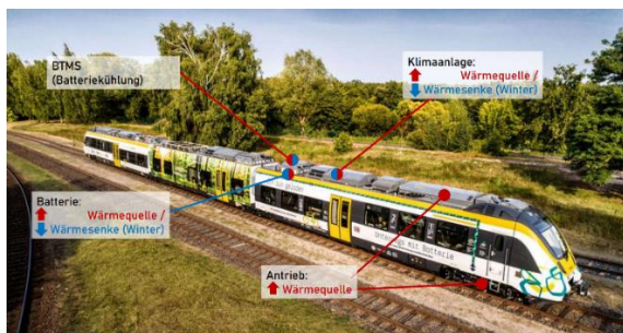
Abb. 1 Antrieb, Fahrgastraum und – je nach Antriebssystem – der Energiespeicher eines Zuges müssen permanent im jeweils idealen Temperaturfenster gehalten werden © ALSTOM Transportation Germany GmbH
