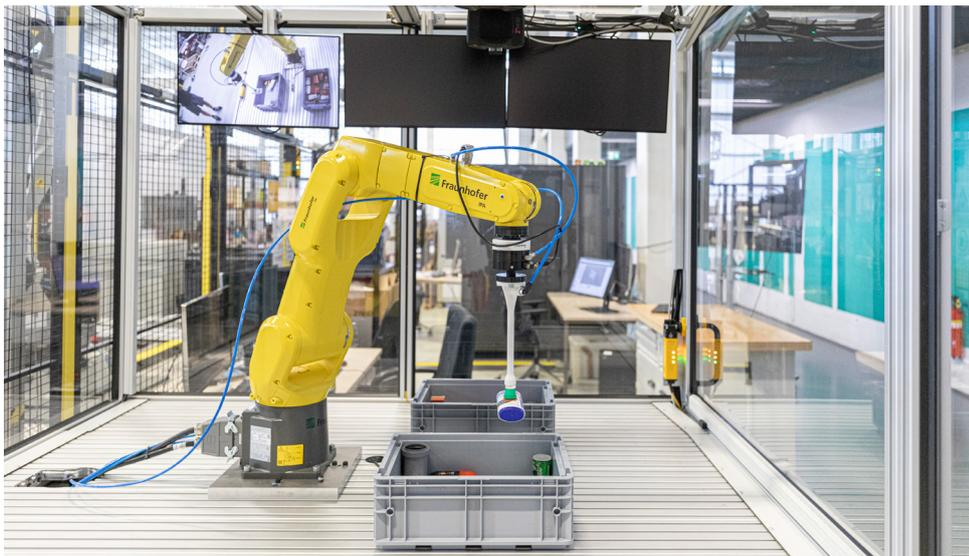
Neben dem flexiblen Handhaben von Objekten entwickelt das Fraunhofer IPA unter anderem Lösungen für das roboterbasierte Schweißen, den Einsatz von Simulationen sowie roboterbasierte Intralogistikprozesse. Quelle: Fraunhofer IPA/Foto: Rainer Bez.
