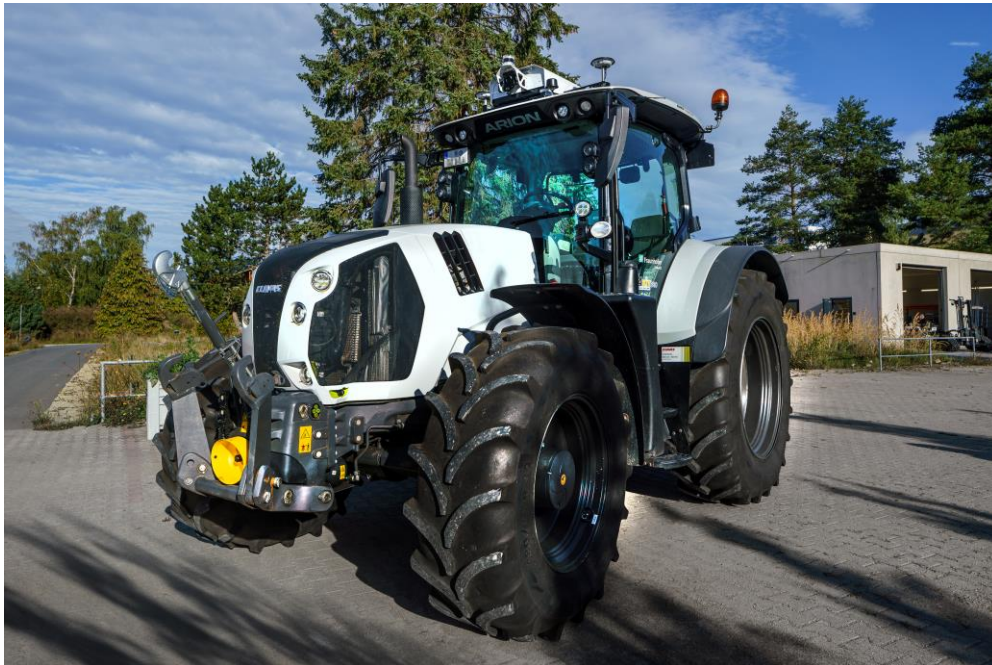
Nachrüstkit auf dem Kabinendach der Zugmaschine. Bild: Fraunhofer IOSB-AST
