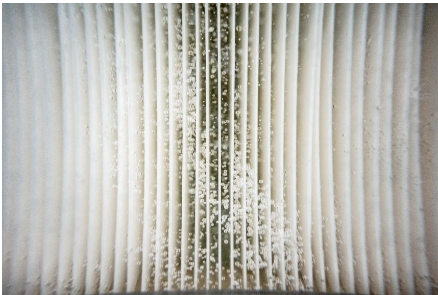
Bildunterschrift: Forschung an Membranbelebensreaktoren: Durch optimierte Strömungsführung und Belüftung mit Luftblasen sollen Ablagerungen auf der Membranoberfläche verhindert und der Energieverbrauch reduziert werden (Foto: Hochschule Osnabrück).
