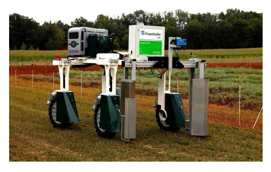
**Bild:** Die Fraunhofer-Gesellschaft präsentiert zahlreiche Neuheiten für das Smart Farming der Zukunft – darunter unser Highlight: der Feldroboter DeBiFiX. Dieses innovative Gerät ermöglicht Landwirten präzise Biomassebestimmungen direkt auf dem Feld. (© Katja Hofacker, Kompetenzzentrum für Digitale Agrarwirtschaft – KoDA)
