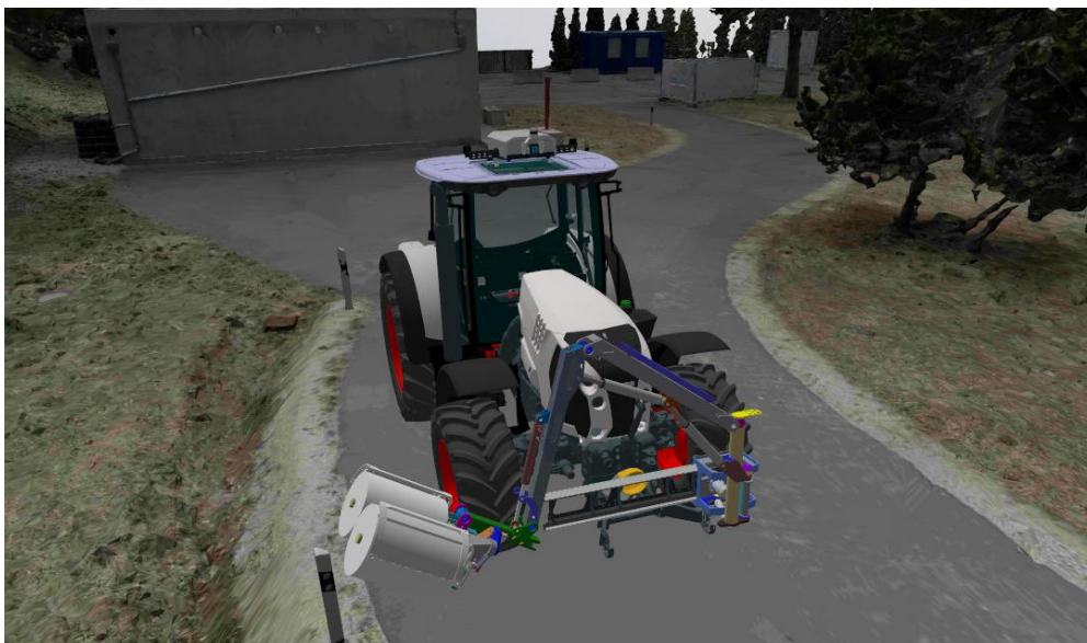
Abbildung 2: In der Simulation des digitalen Zwillings des Reallabors für autonome Arbeitsmaschinen reinigt der autonome Traktor mit Ausleger und Arbeitsgerät einen Leitpfosten. Ausführende Forschungseinrichtung ist das Fraunhofer IOSB-AST in Ilmenau. Foto: Fraunhofer IOSB-AST Public
