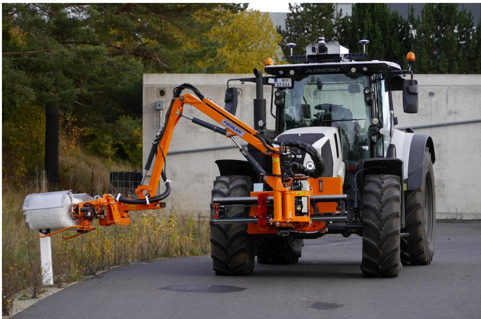
Abbildung 1: Im „Reallabor für autonome Arbeitsmaschinen“ am Fraunhofer IOSB-AST in Ilmenau reinigt der autonome Traktor ARION mithilfe eines Anbaugeräts einen Leitpfosten. Foto: Nadine Knechtel, Fraunhofer IOSB-AST
