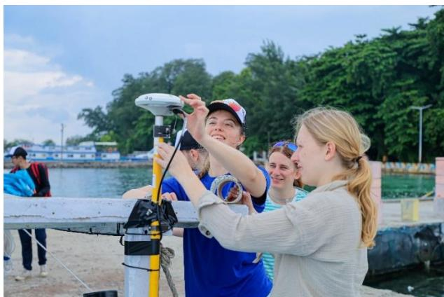
Annika Walter, Ellen Heffner und Annette Scheider von der HCU beim Aufbau der GNSS Antenne, die mittels globaler Satellitennavigationssysteme (GNSS) präzise Positionsdaten liefert
