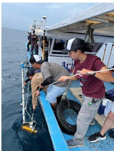
Mitarbeitende des indonesischen Instituts Teknologi Bandung (ITB) installieren das Underwater LiDAR System ULi am Boot, ca. 50 cm unter der Wasseroberfläche. ULi vermisst 3D-Strukturen unter Wasser und kann grundsätzlich hunderte Meter tief tauchen. Dabei erfasst der Scanner Objekte millimetergenau über Distanzen bis zu zwanzig Metern, wenn es die Trübung zulässt.
