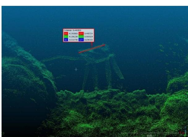
Der Underwater LiDAR Scanner ULi nimmt Daten vom fahrenden Boot aus auf: Die Unterwasser-Punktfolge einer Fläche von 2,5 × 2,5 m zeigt Strukturen wie diesen metallenen Messrahmen, der in ca. 8 m Tiefe ins Wasser gelassen wurde und somit zur Analyse der räumlichen Auflösung und Präzision dient
