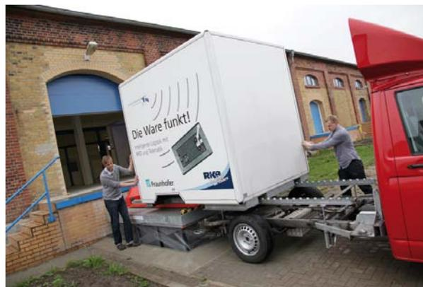
Der Kleintransporter mit Wechselbehälter wird vom Fraunhofer IFF im Galileo-Testfeld-Sachsen-Anhalt entwickelt. Ab dem Herbst 2011 testen die Forscher ein Konzeptfahrzeug mit Elektroantrieb. Die Batterie befindet sich in den schnell auswechselbaren Containern, womit sich neue Logistikkonzepte und Reichweitenverlängerung für Elektrofahrzeuge kombinieren lassen.
