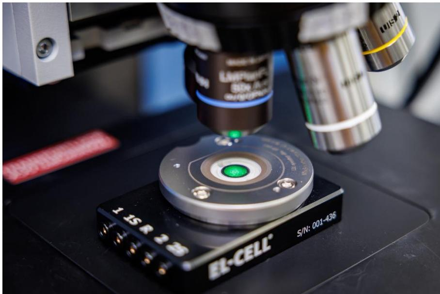
Raman-Mikroskop am Fraunhofer THM, das im Projekt SALSA zur operando-Analytik von Elektroden und Elektrolyten der Aluminium-Ionen-Batterie (AIB) eingesetzt wird.
