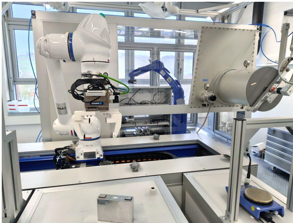
Anlage zur automatisierten Zerlegung von Batterien für das Projekt ReUse im Fraunhofer ISC © Fraunhofer ISC
