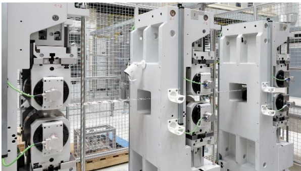
Abb. 3 Kontinuierliche Fertigung im Hohlprägewalzverfahren: hochpräzise, hochratenfähig und energieeffizient.
