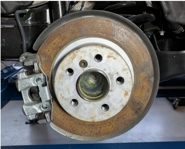
Abb. 2 Starker Rostansatz und mit Riefen: Grauguss-Bremsscheibe, die eine Hauptuntersuchung (»TÜV«) nicht mehr bestehen würde. Ein sicherer Weiterbetrieb des Fahrzeugs ist bei einem solchen Tragbild der Bremsscheibe nicht mehr möglich. © Fraunhofer IWU
