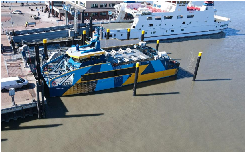
Bildunterschrift: Wenn die Fähre im Hafen anlegt speisen neben der PV-Anlage der Reederei auch die Fahrzeugbatterien der E-Autos auf dem Parkplatz Strom in ihr Ladesystem ein (Foto: Reederei Norden-Frisia).
