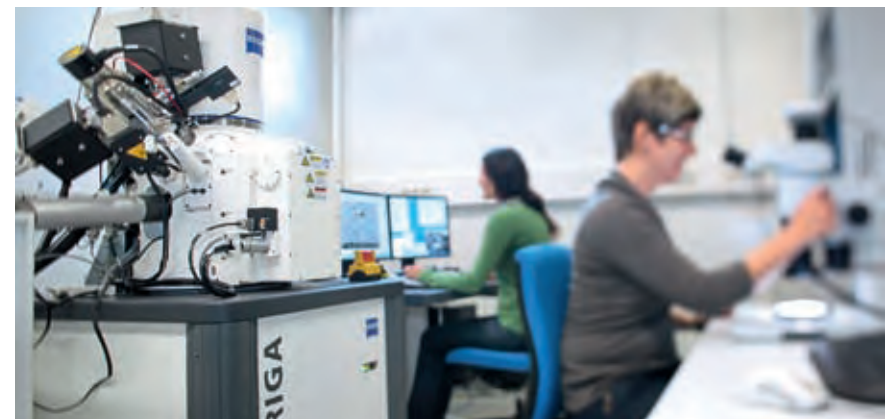
Elektronenmikroskopisches Arbeiten an wasserhaltigen Proben mit FIB/SEM
