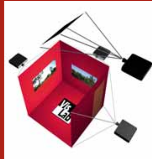
Abbildung 2: Prinzipdarstellung eines CAVE
