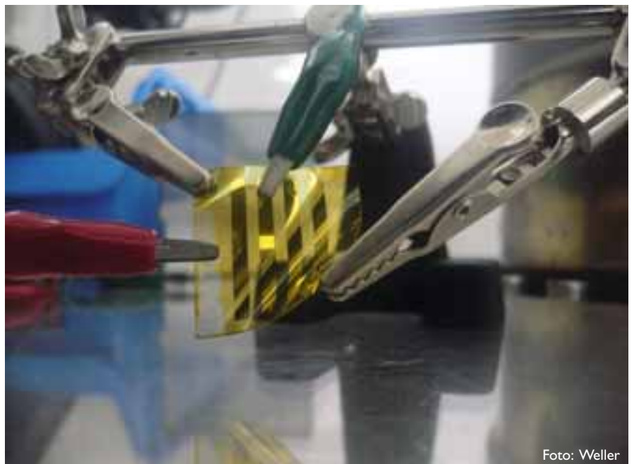
Abbildung 4: Eine an der FH Kaiserslautern, Standort Zweibrücken hergestellte flexible OLED im Betrieb.
