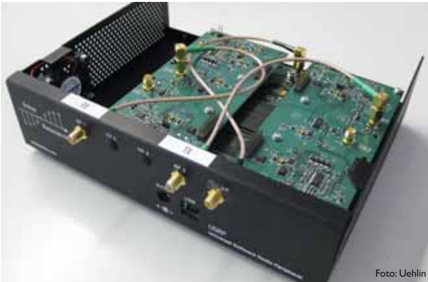
Bild 4: Das Universal Software Radio Peripheral mit Wandlerkarten für den 1800 MHz Bereich
