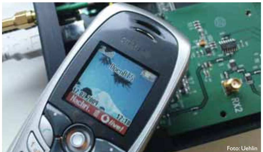
Bild 5: Mobiltelefon eingebucht im OpenBTS-Netz
