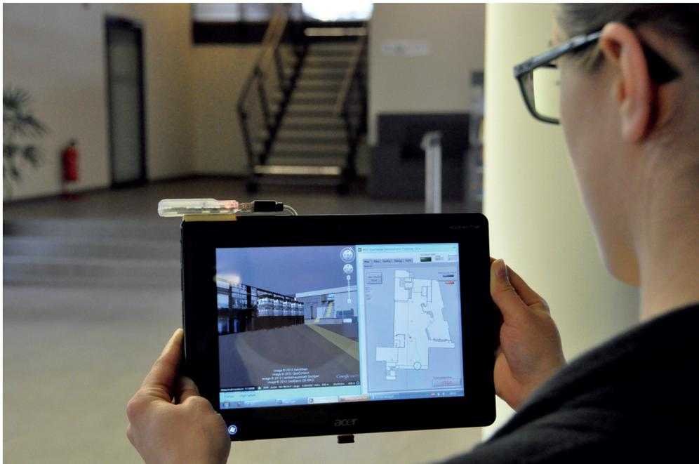
**Tablet-Computer für die Indoor-Navigation. (Quelle: Fraunhofer IPA)**
