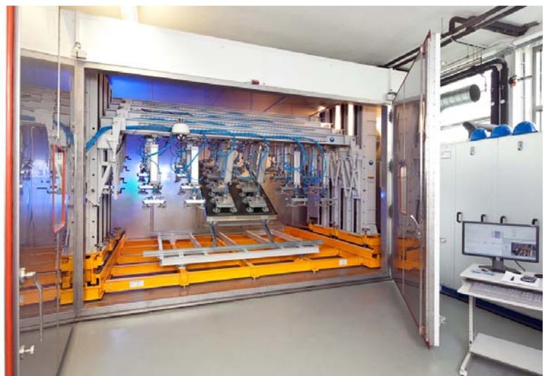
Neuer mechanischer Belastungsprüfstand am Fraunhofer ISE: Für die Untersuchung der Stabilität und Sicherheit der solarthermischen Kollektoren bei Wind- und Schneelasten ist der Prüfstand in eine Klimakammer eingebettet. ©Fraunhofer ISE
