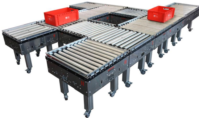
Fördersystem der KIT-Gründung Flexlog: Die Förderstrecke setzt sich aus baugleichen, quadratischen Modulen zusammen und ist sofort einsatzbereit. (Foto: IFL, KIT).
