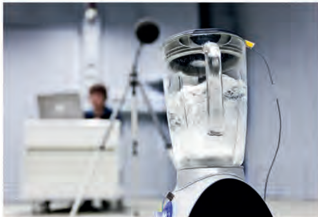
Abbildung: Akustische Untersuchungen im schallarmen Halbraum
