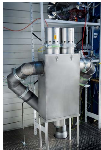
Im Karlsruher Institut für Technologie wurde ein Rußabscheider für Kleinfeuerungsanlagen entwickelt. (Foto: KIT)
