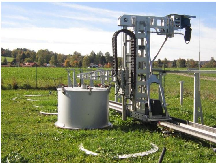
Messroboter: Das vom KIT betriebene Gerät misst Lachgasemissionen aus dem Boden vollautomatisch. (Foto: Dr. Eugenio Díaz-Pines)
