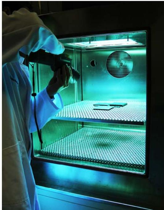
Wissenschaftler des Fraunhofer ISE bei der Überprüfung der Oberflächentemperatur einer Polymerprobe während der UV-Alterung im Klimaschrank mit Hilfe einer Wärmebildkamera. ©Fraunhofer ISE
