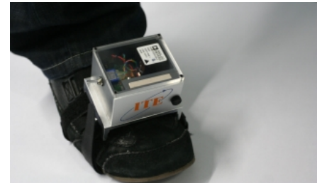
Als „dreidimensionaler Schrittmesser“ registriert der Fußsensor alle Bewegungen im Raum. (Foto: Gabi Zachmann)
