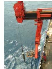
Entnahme eines Sedimentbohrkerns.
