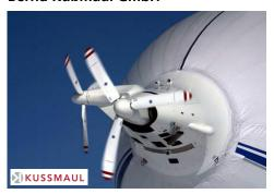
Die Spezialisten aus Weinstadt liefern mit der "Welle Querfan" und der "Nabe Querfan" für die ZLT Zeppelin Luftschifftechnik GmbH & Co zwei entscheidende Teile der Heckantriebseinheit des prominenten Luftschiffs.
