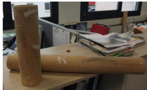
*Prototypen der Furnierschichtholzrohre im Labor, Querschnitt (li.) und Ansicht (re.)*
