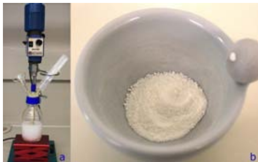
Abb. 1: Herstellung des SA/TSA-Kolloidkomplexes: a) Stufe 2 (eintropfen der \text{CaCl}_2 -Lösung) b) Isoliertes SA/TSA (1:10) Filtrat. © Hohenstein Institute
