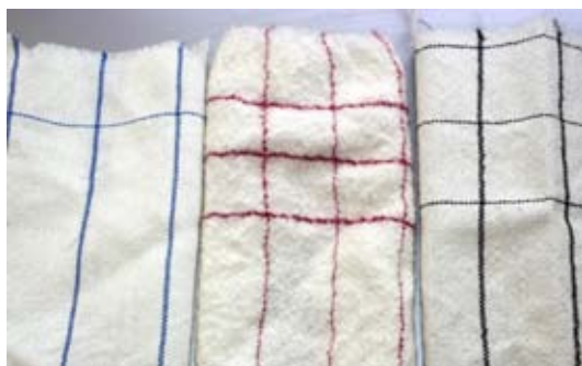
Abb. 2: Mit Silberkolloid und SA/TSA-Komplex ausgerüstete Wolltestgewebe: gebeizt (links), unbehandelt (mitte), filzfrei (rechts). ©Hohenstein Institute
