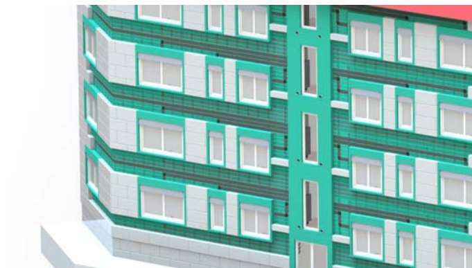
Integration von Leitungen und Rohren in die Fassade eines Demonstrationsgebäudes in Frankfurt aus den 1950er Jahren. ©Fraunhofer ISE
