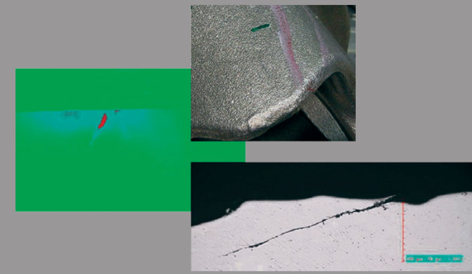
Schmiedeteil mit Riss, von oben nach unten optisches, thermographisches und metallurgisches Bild
