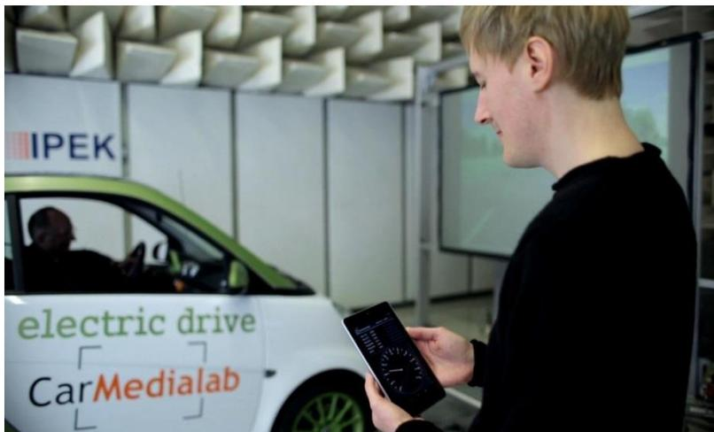
Das Elektroniksystem ELISE stellt Fahrzeugdaten in Echtzeit und kabellos zur Verfügung. (Bild: KIT/e-mobil BW)
