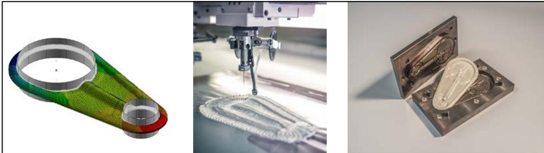
*Drehmomentstütze aus glasfaserverstärktem Kunststoff, hergestellt mittels Tailored Fibre Placement: Modellierung, Preformherstellung, konsolidiertes Bauteil und Werkzeug*
